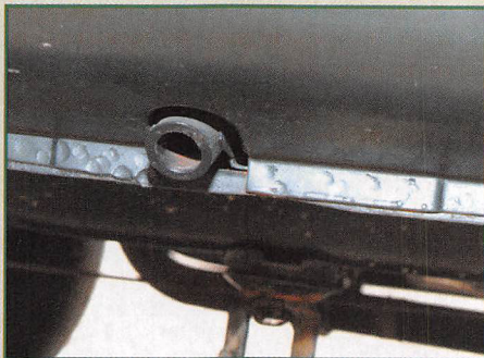
Rund um die Wagenheberaufnahmen muss ein kleiner Ablaufspalt verlaufen
