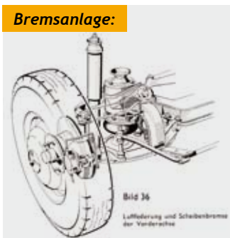
ATE-Scheibenbremsanlage (Lizenz-Dunlop) im 300 SE
