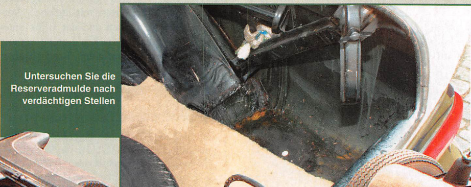
Alles Banane? Verstopfte oder zugeschweißte Abflusslöcher machen ihnen den Garaus
